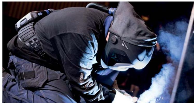
**Erweiterter Schutz:** Eine schwer entflammable Kopfabdeckung (wie in dieser Abbildung verwendet) und ein Ohren-/Halsschutz sind als Zubehör für alle Speedglas 9100 Schweißmasken erhältlich.
